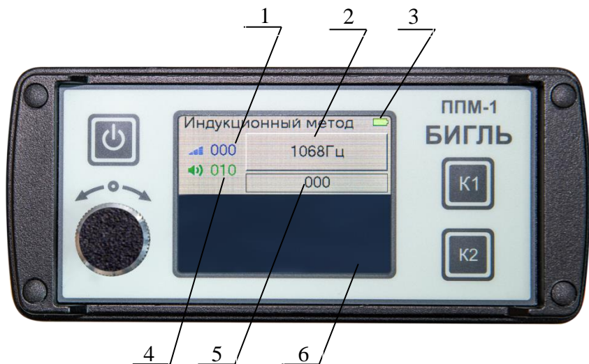
Рис. 10 Экран приёмника ППМ-1 «Бигль» в индукционном режиме
