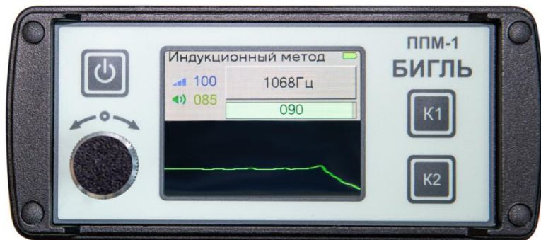
Рис. 13 Промежуточное значение при увеличении чувствительности приемника ППМ-1 «Бигль» (второй проход)
