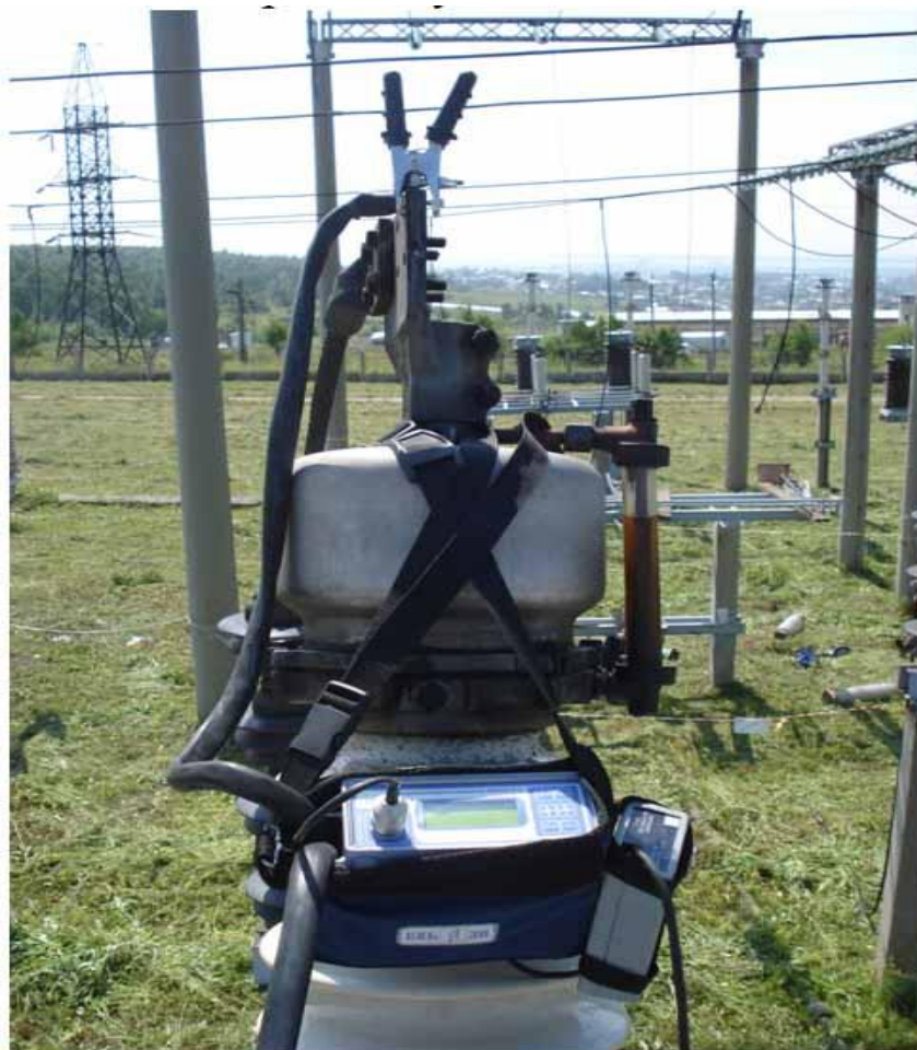
Рисунок 9 – Крепление прибора на полюсе выключателя МКП-110
