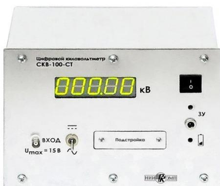
Рисунок 2 – блок измерительный стационарный
