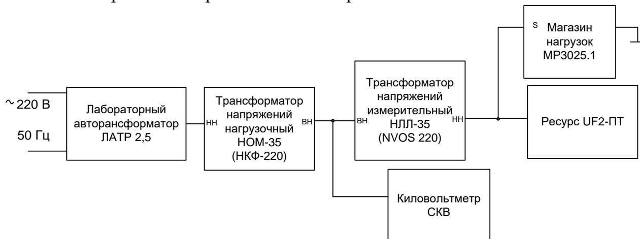
Рисунок 6 – Схема подключения СКВ для проверки действующих значений напряжений переменного тока промышленной частоты
