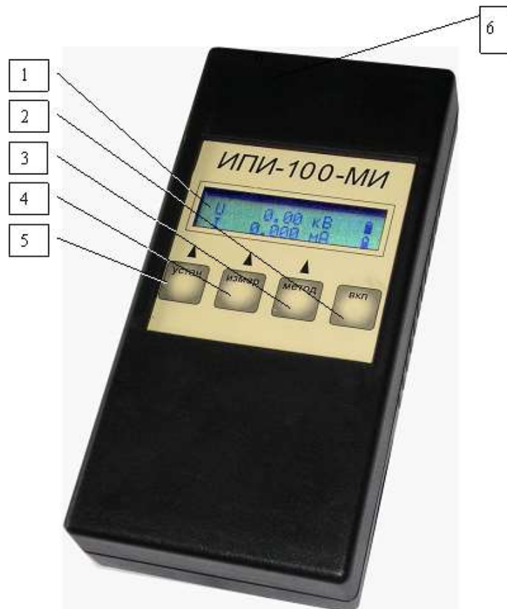
Рисунок 4. Блок индикации ИПИ-100 МИ.
