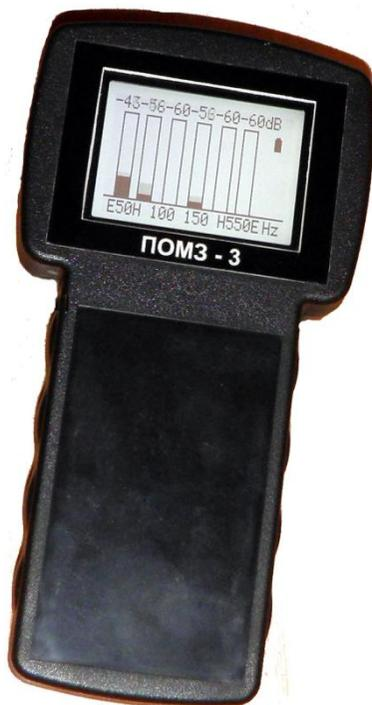
Рис. 1. Внешний вид приемника ПОМЗ-3.
