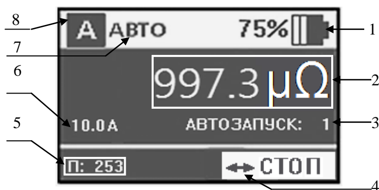
1 – уровень заряда АБ; 2 – результат измерения; 3 – порядковый номер автозапуска; 4– подсказка: обозначение кнопки для выхода из режима «АВТО»; 5 - порядковый номер результата измерения; 6 - фактическая сила измерительного тока; 7 – полное название режима измерений; 8 – буквенное обозначение режима измерений Рисунок 6 – Окно с результатом измерения в режиме «АВТО»
